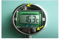
③ 液晶ユニット基板の上下のビスを外します。矢印ヶ所
